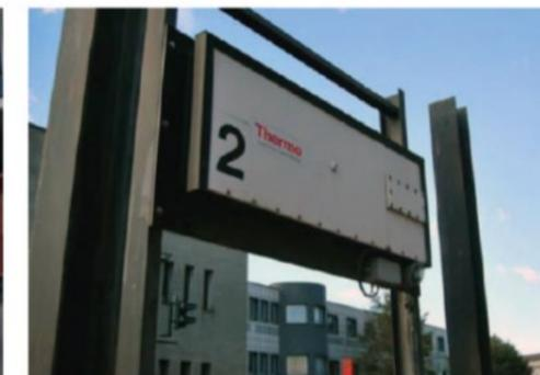
Rilevatori di radioattività all'ingresso dello stabilimento
